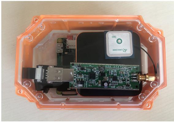
Fig. 5: Imagen del prototipo de sensor de RF para la captación de señales GNSS que se ha desarrollado en este trabajo.
