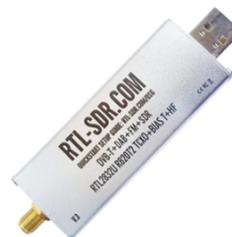
Fig. 3: Cabezal de RF basado en SDR, RTL-SDR.
